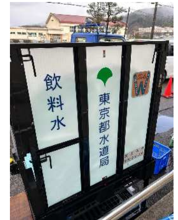
⑤東京都が提供している給水タンク（仮設水槽）1㎡の水道水が貯められます。
