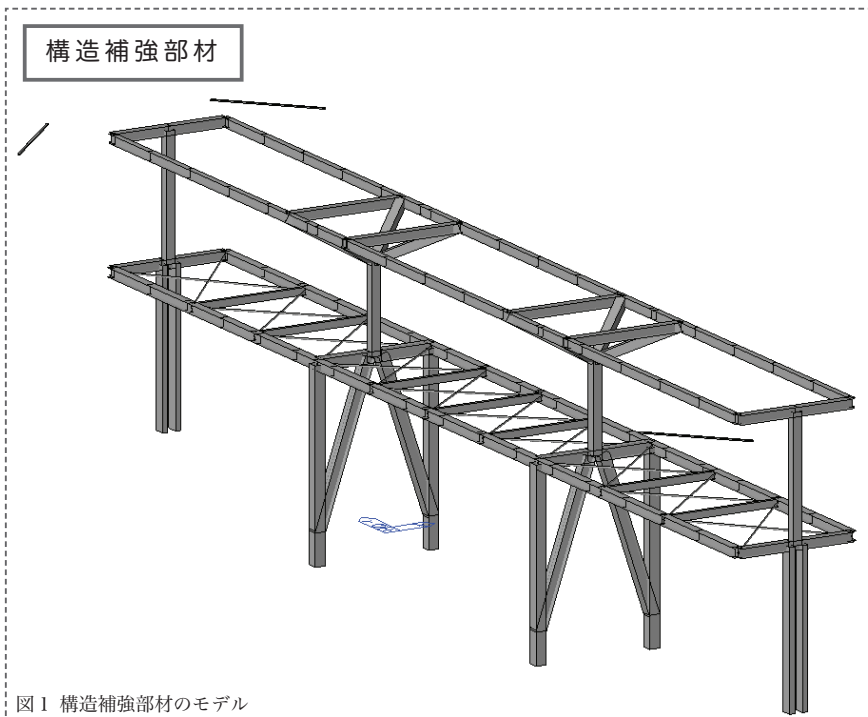
図1 構造補強部材のモデル
