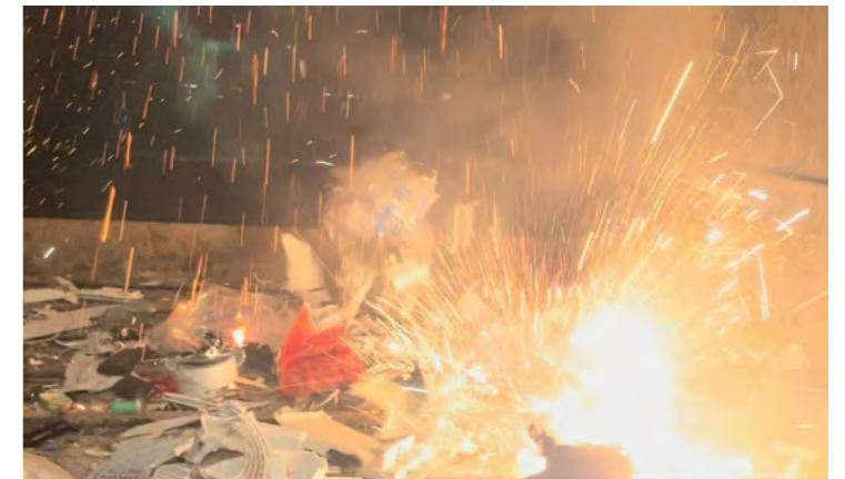
小山川クリーンセンターで小型充電式電池が発火する様子
