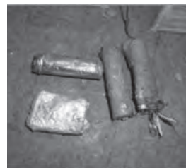
▼小山川クリーンセンターで発火した小型充電式電池
