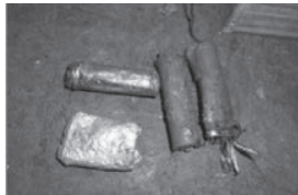
◀小山川クリーンセンターで発火した小型充電式電池
