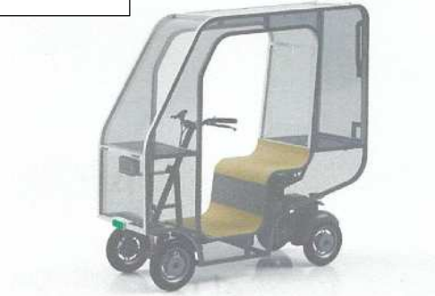
次世代モビリティ (Howdy TRANS) 時速: 6 km/h、20 km/h (スイッチにより切り替え可能)
