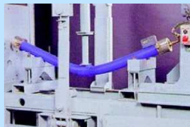
耐震管(水道配水用ポリエチレン管) 写真提供：
