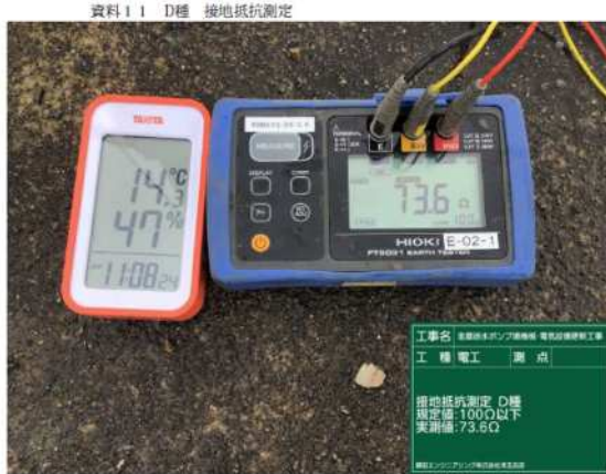
資料11. D種 接地抵抗測定
