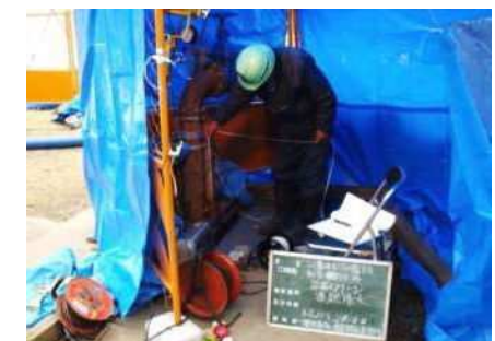
揚水試験による井戸能力の確認
