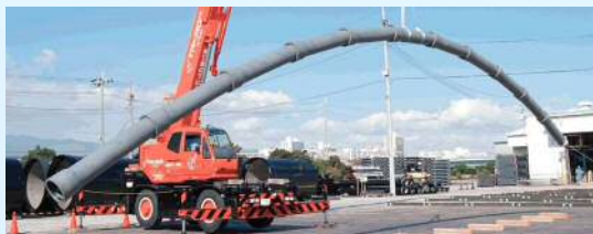
耐震管 (GX 形ダクタイル鋳鉄管)
