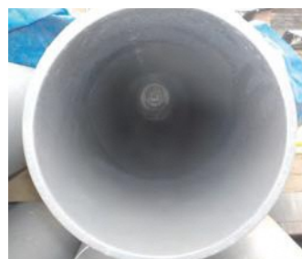
●更新工事で使用している新しい管の内部
