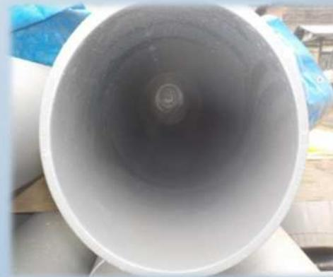
更新工事で使用する新しい水道管の内部
