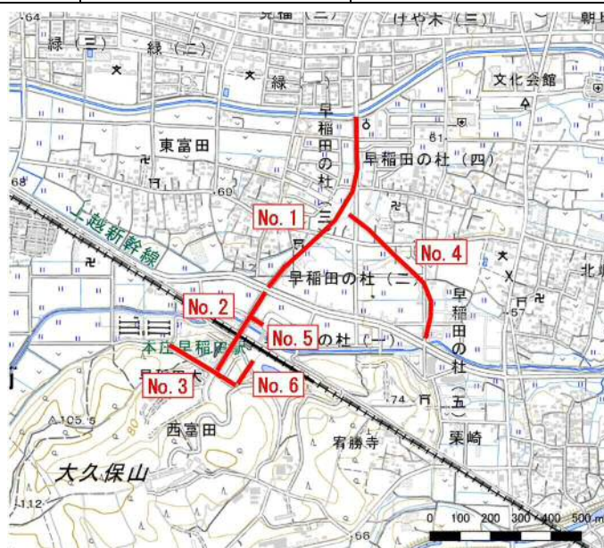
図 2-6 本庄市内における無電柱化整備済み路線（本庄市管理路線）
