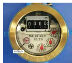
▲メーター器内のパイロット
