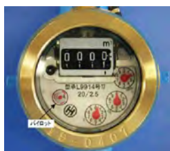
▲メーター器内のパイロット
