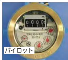
メーター器内のパイロット
