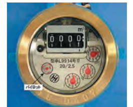
▲メーター器内のパイロット
