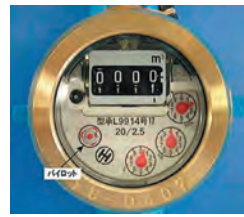
▲メーター器内のパイロット
